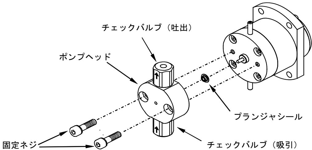
⑦ポンプヘッドに装着されているプランジャシールの穴に交換工具のガイド棒を差し込んで、プランジャシールを取り外します。
